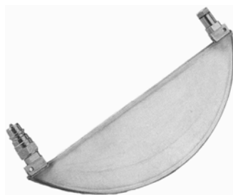
Slika 2 - Uređaj za unošenje sile na prošlicano mjesto u betonskoj konstrukciji
